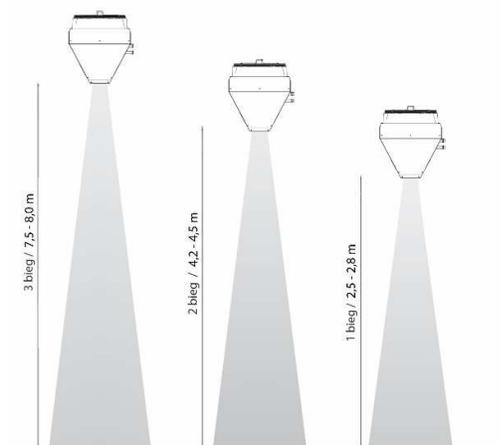
RYS. 2.2 ZASIĘG POWIETRZA NA POSZCZEGÓLNYCH BIEGACH.
