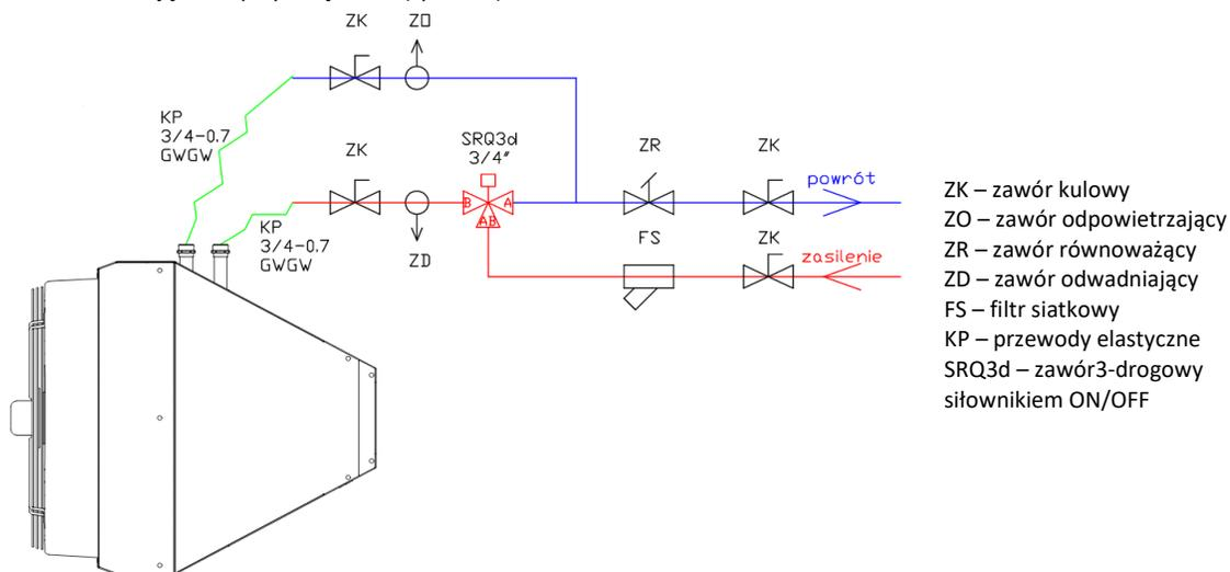
RYS. 16.1. PRZYKŁADOWY UKŁAD PODŁĄCZENIA ELEMENTÓW HYDRAULICZNYCH.
