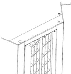
Urządzenie wyposażone jest w regulowane kratki wylotowe. Kratkę naprowadzającą powietrze nadmuchiwane należy regulować ręcznie. Zakres regulacji to  $\pm 17^\circ$ . W celu zmiany kierunku powietrza wylotowego należy równocześnie na obu końcach kratki ustawić ten sam kąt. Nadmuch powietrza z kratki wylotowej powinien być ukierunkowany jak najbliższej płaszczyzny otworu drzwiowego (uwzględniając warunki panujące przy otworze drzwiowym, w tym napór wiatru i podciśnienie).
