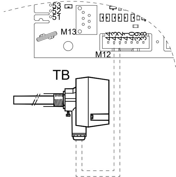
TB DHW thermostat (alternative to DHW buffer tank probe)
