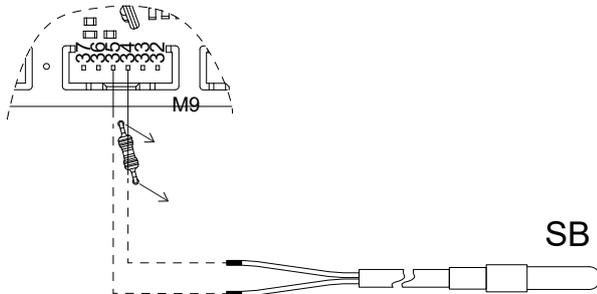
SB DHW buffer tank probe OSND011
